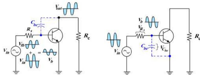
أ - تأثير السعة  $C_{be}$  ، حيث ينخفض جهد الخرج  $V_{out}$  بـ - تأثير السعة  $C_{be}$  ، حيث إن جزء من جهد الخرج  $V_{out}$  يعود خلال المكثف  $C_{be}$  إلى القاعدة وينخفض إشارة الدخل  $V_{in}$  بسبب انعكاس طوره مع طور الدخل
