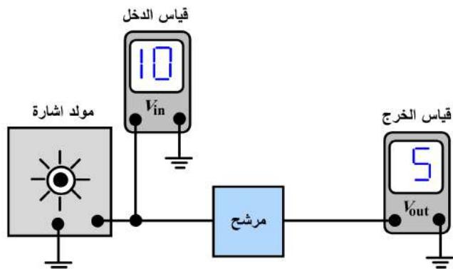
الشكل 108 دائرة قياس استجابة المرشح بطريقة النقطة المحددة. (القراءات المبنية افتراضية وللعرض فقط).
