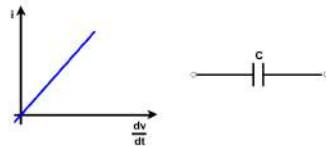
الشكل 33 المخطط الرمزي ومنحنى الجهد - التيار لمكثف نموذجي.
