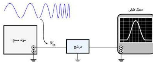
الشكل 109 قياس استجابة المرشح بطريقة مسح التردد.
