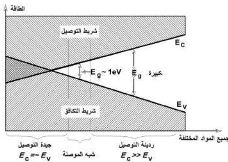
الشكل 37 تصنیف المواد طبقاً للتوصیل الکهربی بواسطة مخطط الطاقة.
