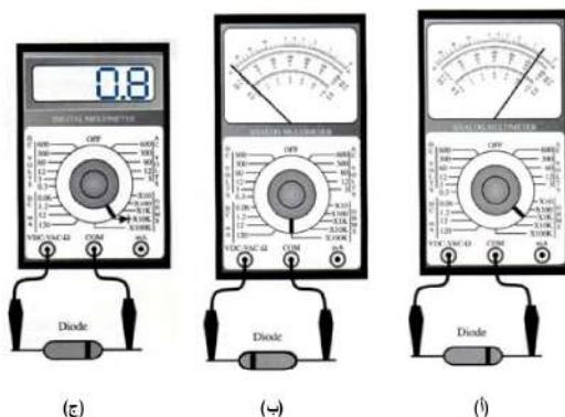
الشكل 104 طريقة فحص الدايمود بواسطة الألقميتير: (أ) يظهر الفحص الأمامي قيمة مقاومة صغيرة جداً، (ب) يظهر الفحص العكسي قيمة مقاومة كبيرة جداً و(ج) وضع فحص الدايمود على مقياس رقمي (DMM) يعطي جهد أمامي عبارة عن حاجز الجهد + هبوط الجهد عبر المقاومة الأمامية.
