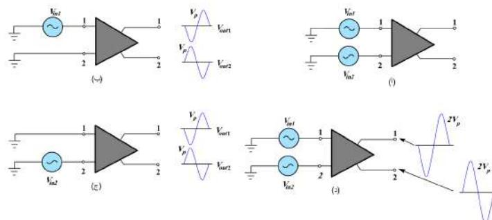
الشكل 21 تشغيل النمط التفاضلي للمكبر التفاضلي. (أ) دخول تفاضلي، (ب) الخروج نتيجة للدخل  $V_{in1}$ ، (ج) الخروج نتيجة للدخل  $V_{in2}$  و(د) المخرج الكلية نتيجة للدخول التفاضلي.
