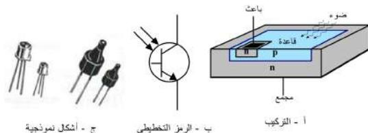
الشكل 61 تركيب ومخطط وبعض أشكال الترانزستور الفوتونى.
